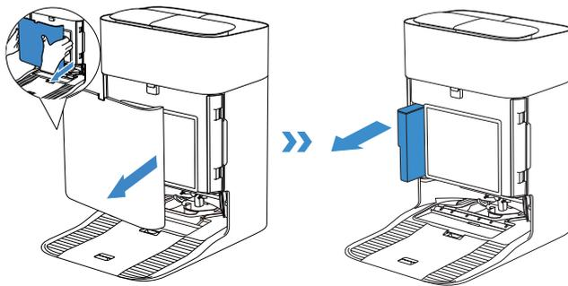
2. Öffne den Tankdeckel und befülle ihn mit ECOVACS-Reinigungslösung. Setze den Deckel auf und bringe den Tank wieder an der Station an.
