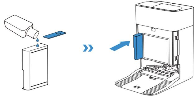
**Hinweis:** Das Reinigungsmittel wird automatisch abgepumpt. Gib kein Reinigungsmittel in die Wassertanks.
