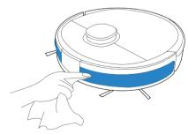
\* 清理下視感應器和紅外緩衝防撞板時請使用乾布。請勿使用濕布,以防 進水造成損壞。
